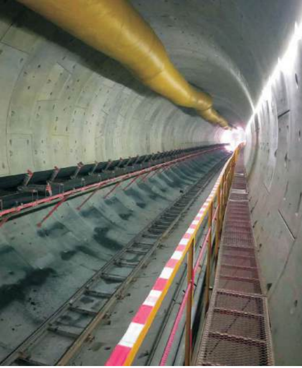
Guangzhou Foshan TBM Metro sürekli bantlı konveyör projesi. 2 adet tünel cüruf çıkarma bantlı konveyörü, 1000mm bant genişliğinde, 3.15m/s bant hızında, 800t taşıma kapasitesine ve 6.3km/adet uzunluğundadır.
